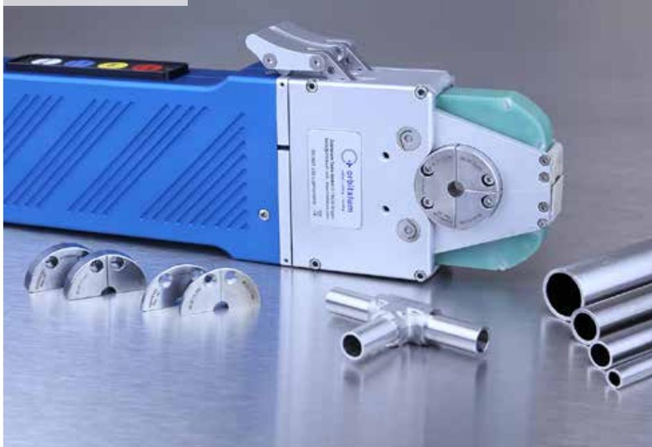
3-geteilter Spannmechanismus - auch im geöffneten Zustand ragen keine Teile über die Kopfkantur hinaus
