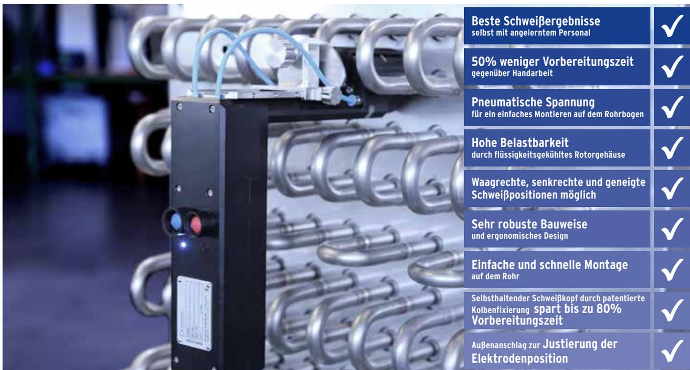
**Alle marktüblichen geschlossenen Orbitalschweißköpfe oder offenen Schweißzangen sind aufgrund ihrer Baugröße nicht geeignet für ihre Positionierung zwischen den einzelnen Rohren von Lamellenwärmetauschern.**
