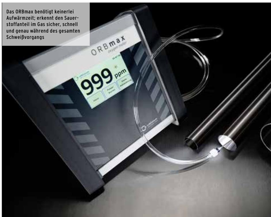
Das ORBmax benötigt keinerlei Aufwärmzeit; erkennt den Sauerstoffanteil im Gas sicher, schnell und genau während des gesamten Schweißvorgangs
