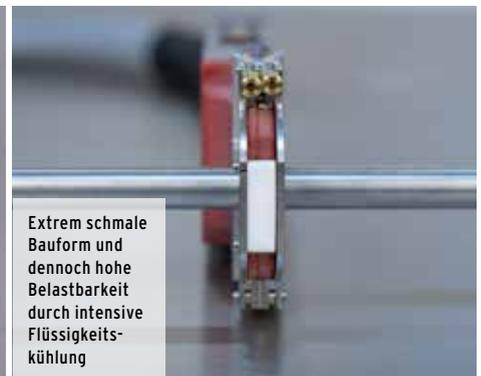
Extrem schmale Bauform und dennoch hohe Belastbarkeit durch intensive Flüssigkeitskühlung
