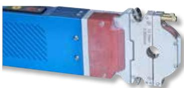
ORBIWELD 12 mit schmaler Spannkassette (Typ "A")
